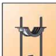
1. Установить нижнюю половину хомута на шпильки.
