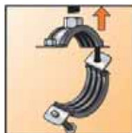
1. Навинтить хомут на шпильку и открыть его.
