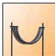
1. Смонтировать нижнюю половину хомута на шпильки.
