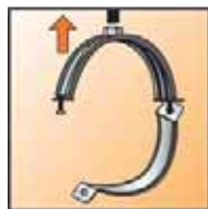
1. Навинтить хомут на шпильку и открыть его.
